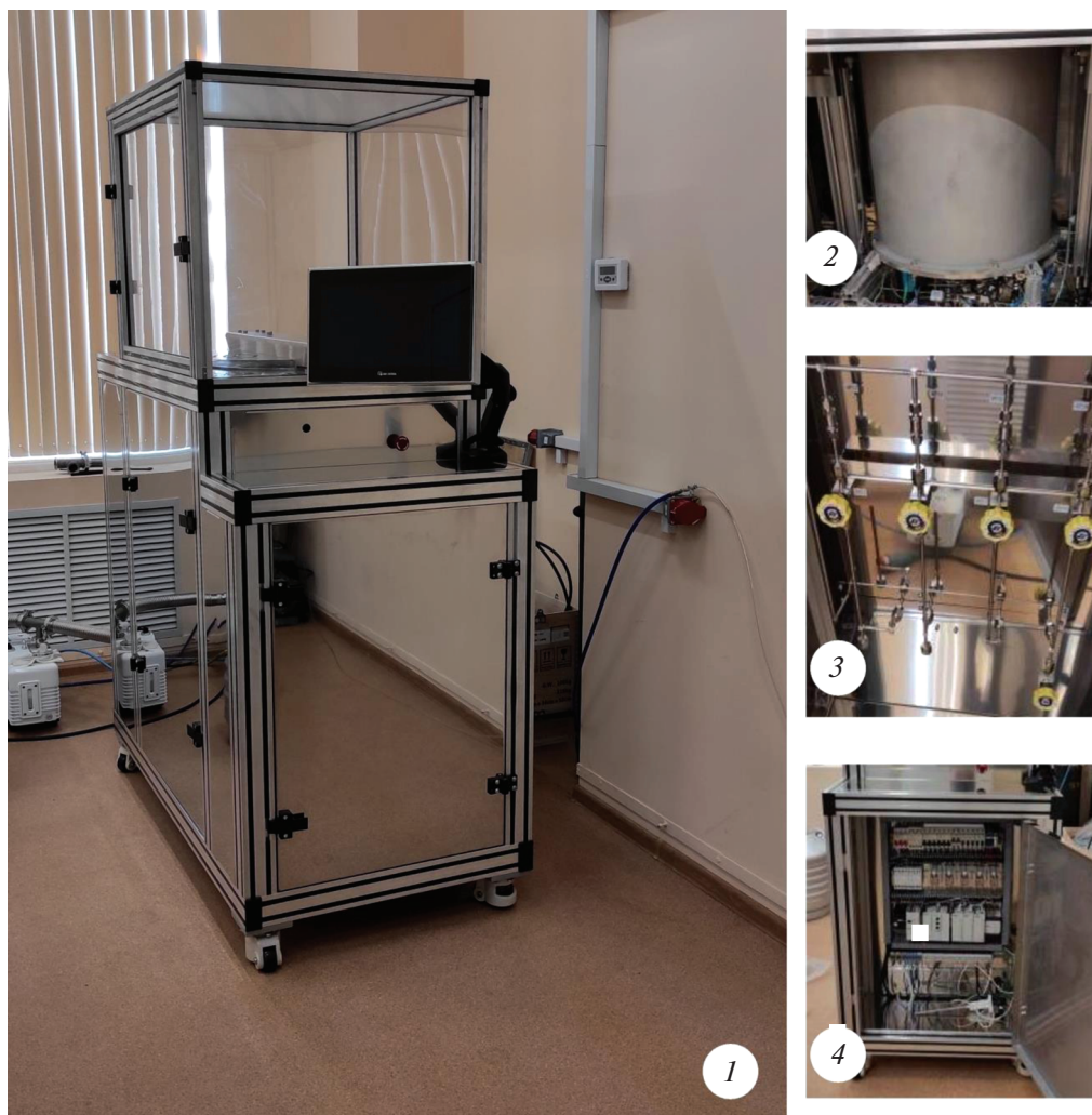
Рис. 6. Установка МН проточно-вакуумного типа с реактором объемом 30 л: 1 — общий вид установки; 2 — реактор; 3 — блок подачи реагентов; 4 — блок автоматизации.
